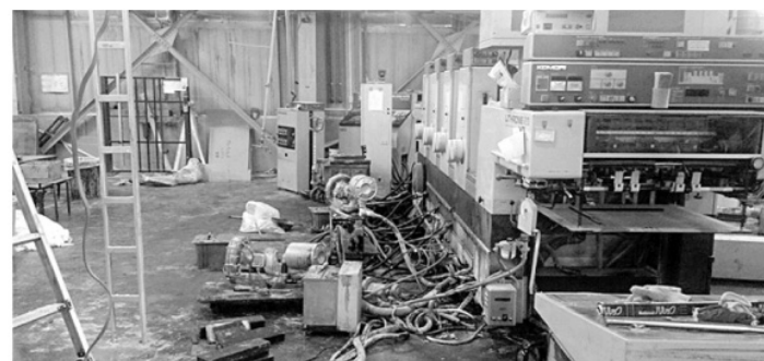
▲地震の揺れで旧本社工場内の輸転機や印刷機は土台から外れ、印刷に支障が出るなどの被害が発生した
